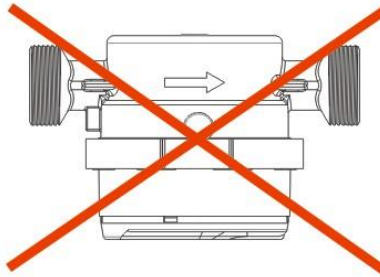
Rys. 2. Zakazane pozycje zabudowy wodomierzy produkcji Apator Powogaz SA typu JS (DN 15-40).
