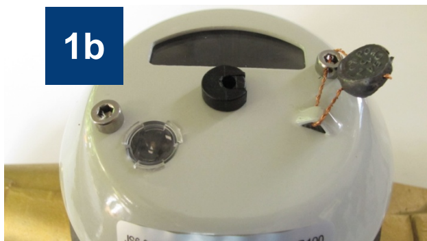
1b Wodomierz typu JS-16-01-NKP (przystosowany do montażu nadajnika NK). Liczydło IP65 wyposażone w oprawę z jednym magnesem, zamontowaną w położeniu wskazówki (x0,01) impulsowanie 100l=1imp.
