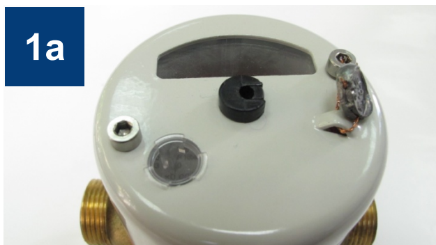
1a Wodomierz typu JS-4-NKP (przystosowany do montażu nadajnika NK). Liczydło IP65 wyposażone w oprawę z jednym magnesem, zamontowaną w położeniu wskazówki (x0,001) -> impulsowanie 10l=1imp.
